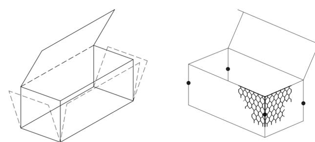
SOLLEVARE GLI SPORTELLINI LATERALI E FISSARE GLI SPIGOLI SUPERIORI CON UNO O PIU' PUNTI. LE OPERAZIONI DI FISSAGGIO SI POTRANNO COMPIERE USANDO IL FILO FORNITO COL GABBIONE O CON APPOSITI PUNTI MECCANIZZATI POSATI MANUALMENTE O CON PISTOLA PNEUMATICA.
